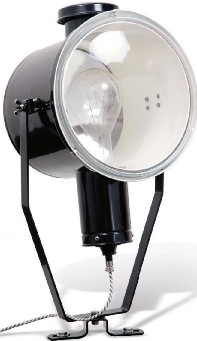
Ein kantiger Scheinwerfer als Strahler mit zylindrischem Reflektor und massiven Trägerbügeln. Aus traditionell gefertigten Drückteilen sowie einzelnen Guss-elementen und gewölbtem Echtglas aus einer Traditions-Glashütte. Mit eingesetztem Spiegel-Reflektor aus hochglanzeloxiertem Aluminium zur Erhöhung der Lichtstärke. Auch nach der Montage dreh- und schwenkbar in alle Richtungen, überzeugt der Strahler durch die Klarheit seiner funktionalen Form.
